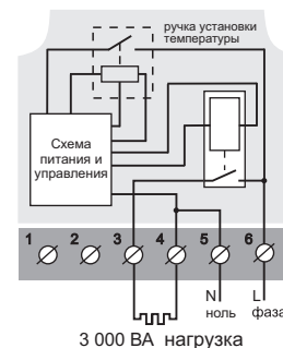
Схема 1. Схема подключения и упрощенная внутренняя схема
